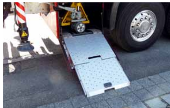
Pfiffige Details erleichtern die Arbeit: Der klappbare Hubwagen hat eine eigene Rampe.
