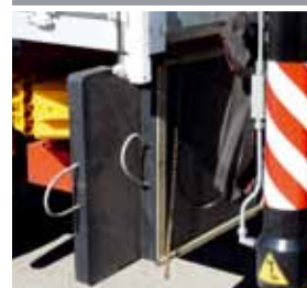
Kontrolliert absenkbar Bordwände durch Gasdruck-Stoßdämpfer: Das spart dem Fahrer Kraftaufwand.
